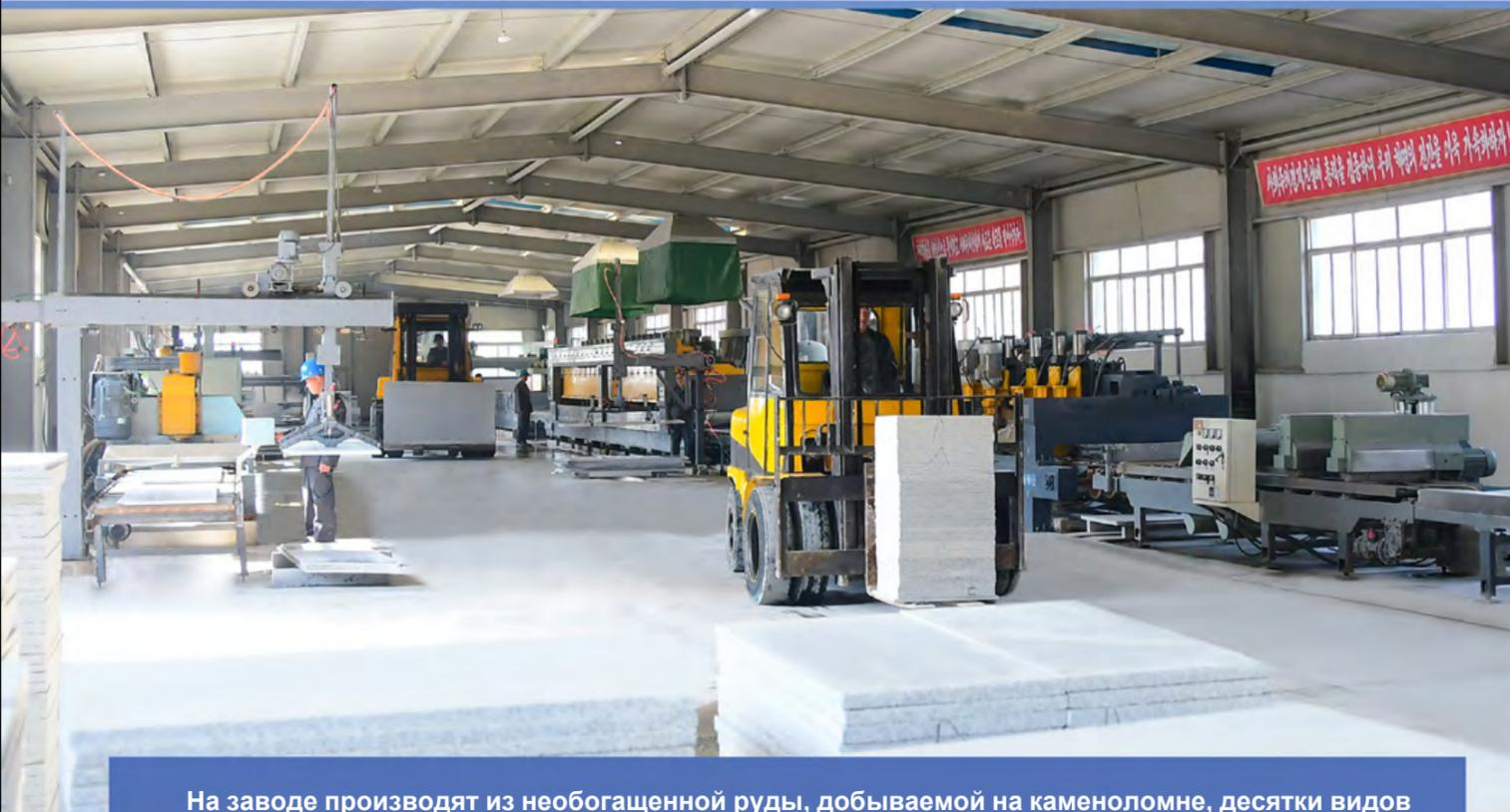
На заводе производят из небогатенной руды, добываемой на каменоломне, десятки видов изделий, в том числе разных размеров плиты, перила и балясины, бордюры и декоративные изделия.
